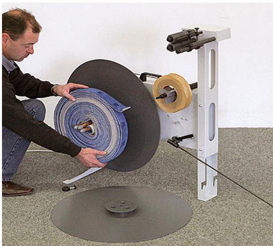
Zum Abnehmen der fertigen Rollen wird die vordere Scheibe gelöst.
