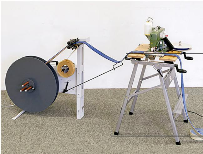
Motorschalterbügel in oberster Stellung. Um eine korrekte Funktionsweise zu garantieren, muss der Einlauf der Kettelleiste 860mm über Aufstellungsort erfolgen
