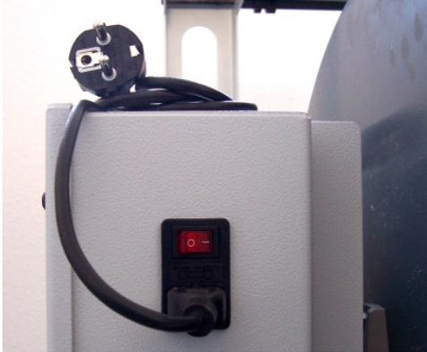
Anschluss entsprechend den gültigen Normen und Richtlinien am Aufstellort ausführen. Spannung und Stromaufnahme gemäß Typenschild überprüfen.
